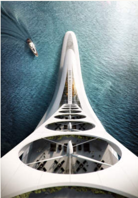
3 Von oben: der Turm als Flügelprofil mit den Turbinenzonen in der Achse, Heliport an der Spitze, die offenen Decks für Forschung und Wohnen dazwischen. 4 Form follows force: der Turm am Rand des Eises, neunzehn Windturbinen im verjüngten Schaft, die Hülle wie eine Haifischhaut. Visualisierung: FlyingArchitecture
